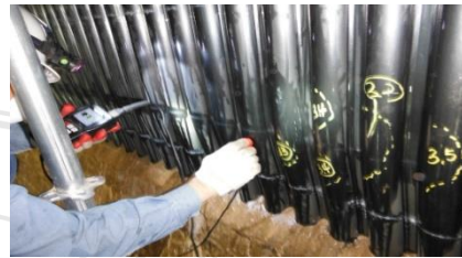
▷ 두께측정 Minimum 두께측정을 통해 Tube의 보수방안을 결정
